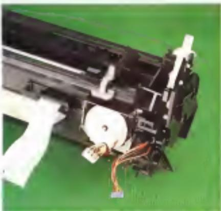
Nel particolare del meccanismo della macchina sono visibili i connettori di collegamento dei motori ed elettronica di controllo ed i due fili cavi di collegamento della testa di stampa
